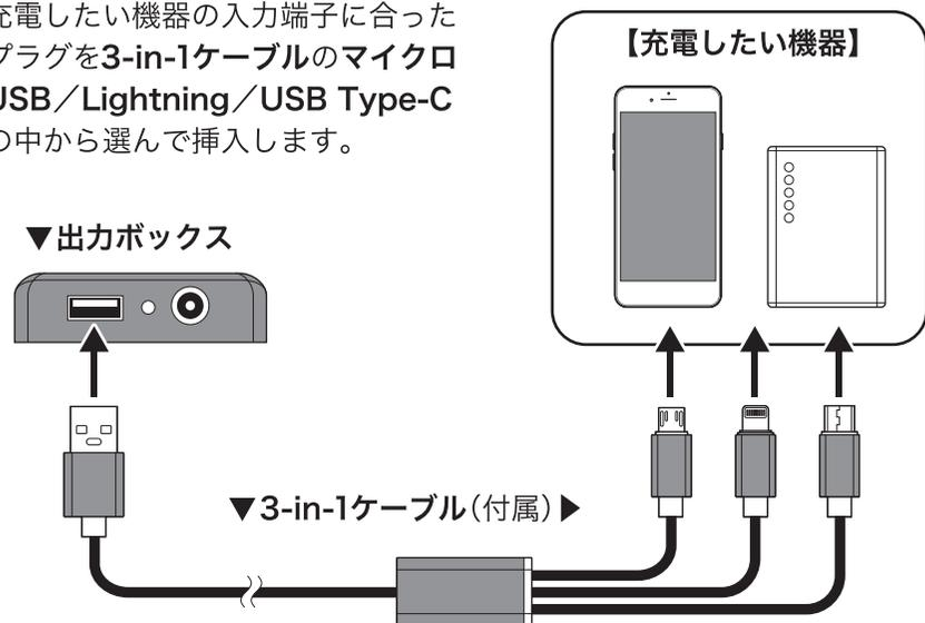
例) 電池容量3,000mAhのスマートフォンの場合、約4時間で満充電になります。
