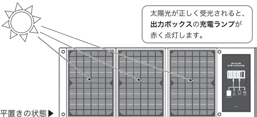
※太陽光の強さ、照射角度によって発電率は変わります。効率良く充電するには、パネルに満遍なく太陽光が当たる様に位置を調整してください。
